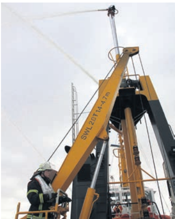
Der Wasserwerfer ist bis auf mehr als 20 Meter ausfahrbar
