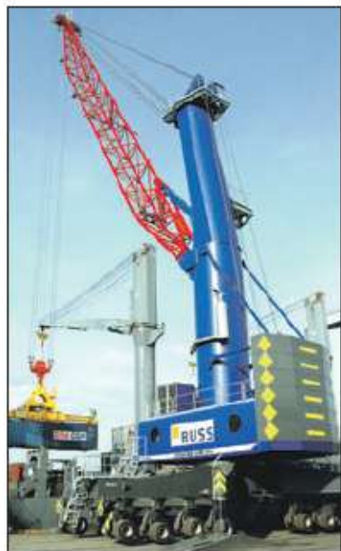
Ende März trifft der Mobilkran ein, der 104 Tonnen heben kann Foto: Buss
